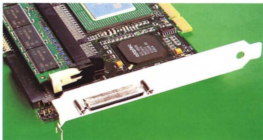
Particolare del connettore esterno ad altissima densità VHDCI sul controller 2100S; i cavi per collegare array esterni che adottano questo standard sono particolarmente costosi (sopra le duecentomila lire...).
